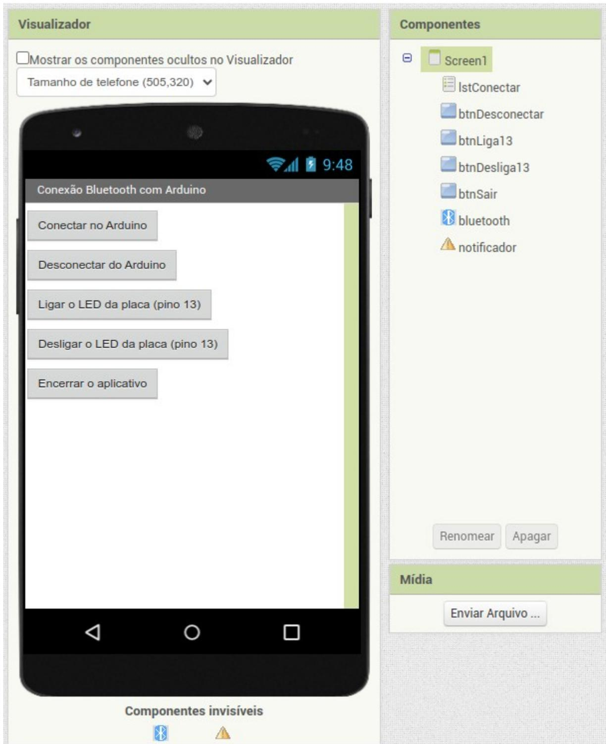
O desenho da tela do App está exibido acima e contém 4 botões (cujos 'nomes' podem ser vistos ao lado do visualizador, na seção de componentes), e dois componentes invisíveis: um cliente *bluetooth* e um notificador. Também há um componente 'EscolheLista' (IstConectar) o qual será responsável por exibir a lista de dispositivos *bluetooth* disponíveis.
