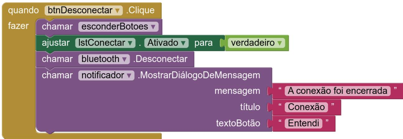
A função da desconexão (além da desconexão do *bluetooth*) é desabilitar os botões e informar o usuário que a conexão foi encerrada. Também será liberada ação sobre a lista de conexões conhecidas.
