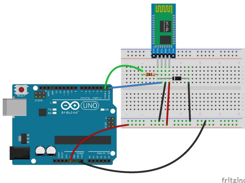
Neste caso o diodo Zener garante que a tensão não passe de 3,3Volts ao módulo (o resistor até pode ser dispensado, o Zener não).
